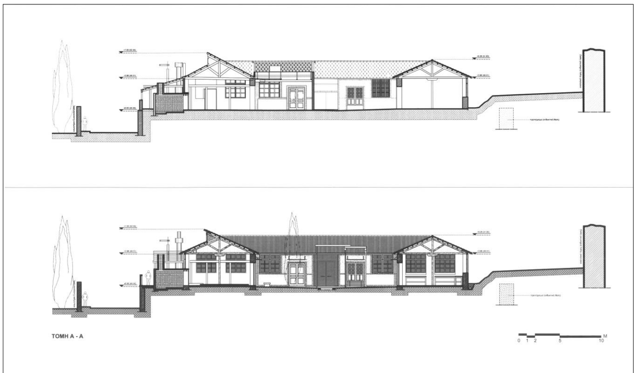
Εικ. 10: Κτίριο Εργαστηρίου της Σχολής Τεχνών και Επαγγελματιών Χαμηδιδέ. α) Ανατολική όψη. Σχέδια αποτύπωσης υφιστάμενης κατάστασης και πρότασης αποκατάστασης (2010) β) Εγκάρσια τομή Α-Α'. Σχέδια αποτύπωσης υφιστάμενης κατάστασης και πρότασης αποκατάστασης (2010). (πηγή: Αρχείο ENM-KM)
